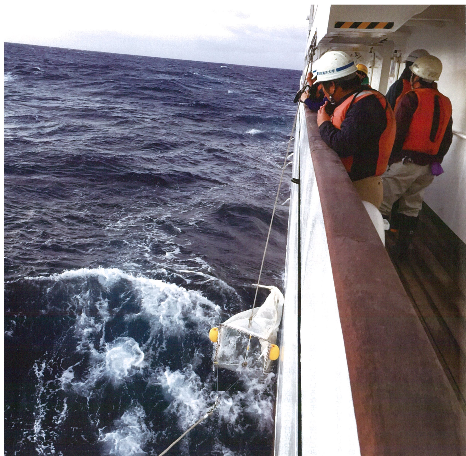
太平洋での浮遊マイクロプラスチックの引き網採取 写真提供 九州大学応用力学研究所附属大気海洋環境研究センター
