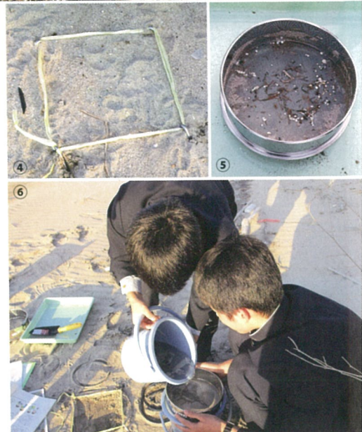
④⑤⑥マイクロプラスチック調査。20cm×20cmの区画から砂を採取し、ふるいにかけて個数を数える
